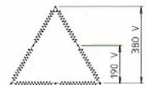
Verlaagd ontdooivermogen (elementen in de aansluitkast ompolen).
